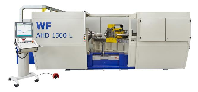
Drückmaschine zur Herstellung von rotationssymmetrischen Drückteilen insbesondere aus Stahl, Edelstahl und Aluminium, sowie aus unterschiedlichen metallischen Werkstoffen, wie z.B. Kupfer oder Niob
