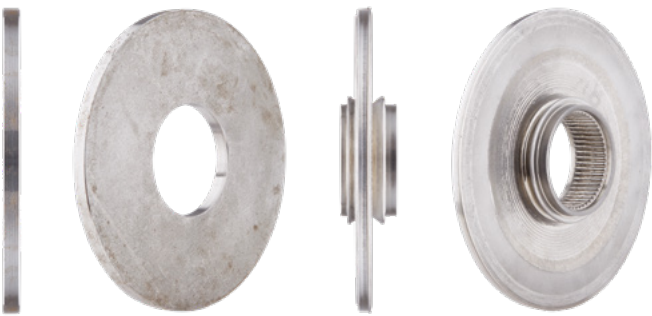
Ausgangswerkstück Ronde und Fertigteil Doppelnabe mit Innenverzahnung
